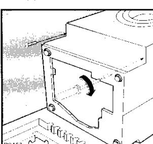
Выньте 3 пластмассовых стержня и закройте отверстия 3 пластмассовыми пробками, которые Вы найдёте на задней стенке.
