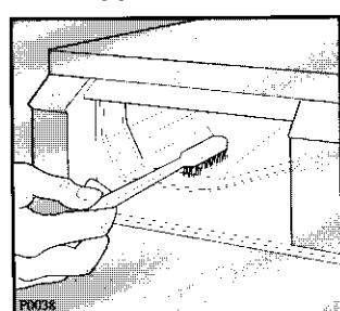
Моющее средство может также отложиться и в нише дозатора, которую следует время от времени прочищать старой зубной щёткой. После выполнения чистки установите дозатор на место и выполните цикл полоскания без белья.
