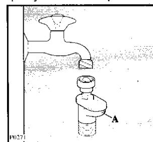
В некоторых машинах наливной шланг оборудован клапаном, предотвращающим вытекание воды из него, что может случиться ввиду нормального старения резины. Эта неисправность обозначается красным сектором в окне "A". В случае необходимости закройте кран и обратитесь в Сервисный центр для замены шланга.
