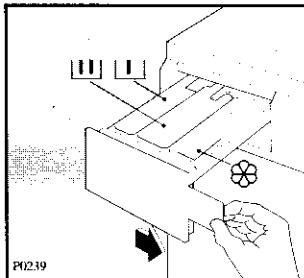
Программная карточка установлена внутри дозатора.
