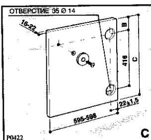
Для установки петель необходимо вы сверлить на внутренней стороне двери два углубления (диаметр 35 мм, глубина 14 мм). Расстояние между углублениями должно составлять 416 мм.
