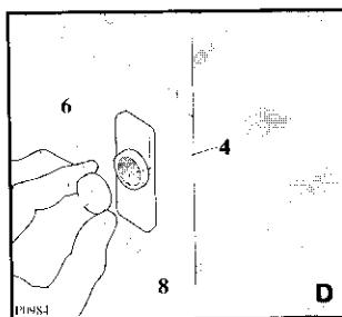
Данное устройство предназначено для магнитной фиксации двери. Для исправной работы этого устройства необходимо закрепить ответную часть магнита (6) (стальной диск + резиновое кольцо) на внутренней стороне двери. Её положение должно соответствовать положению установленного на машине магнита (4) (смотри рисунок D).
